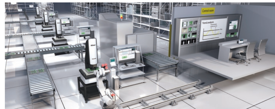
被测件自动传输与NEXIV联动，实现远程控制的全自动测量场景。现场必须采取足够的安全措施，以防人员接近或误入时受伤。
